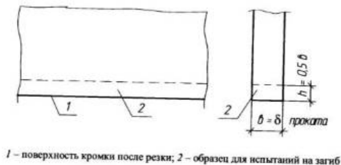
Рисунок Б9.2 - Порядок изготовления образца для испытания кромки на пластичность
